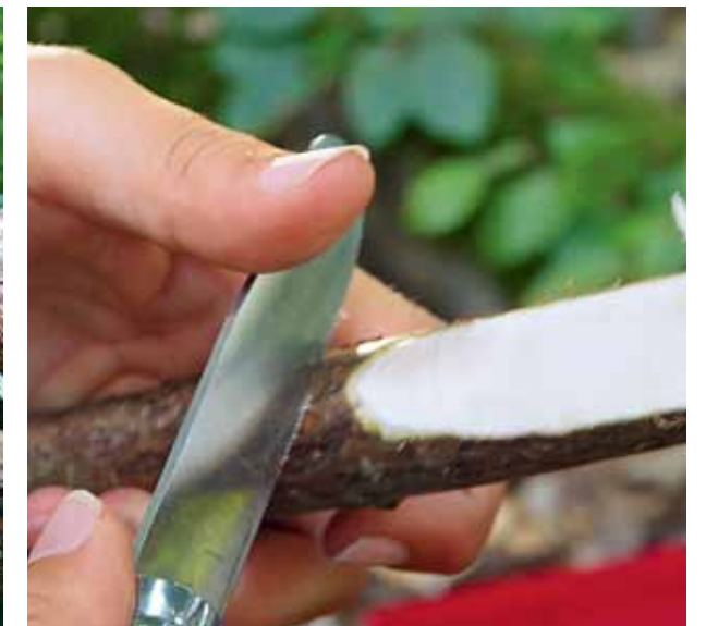
Mit dem Daumendruck auf die stumpfe Klingenseite sind Feinarbeiten möglich.
